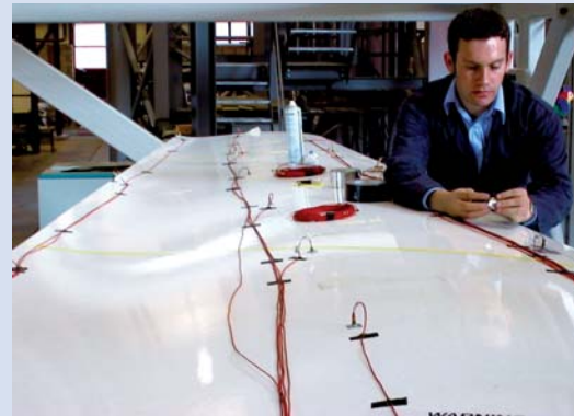
Test de voilure A340 chez Stirling Dynamics (Royaume-Uni)
