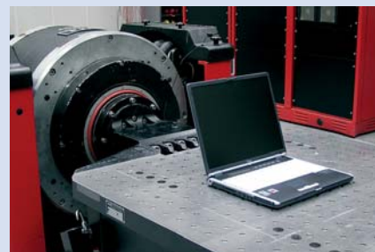
Pilotage d'un moyen d'essai en vibration, Fujitsu Siemens Computers, Augsburg / Allemagne
